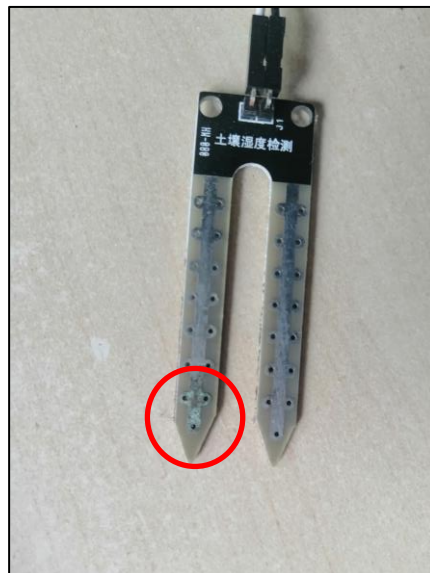
Figura 10. Sensor de humedad corroído
