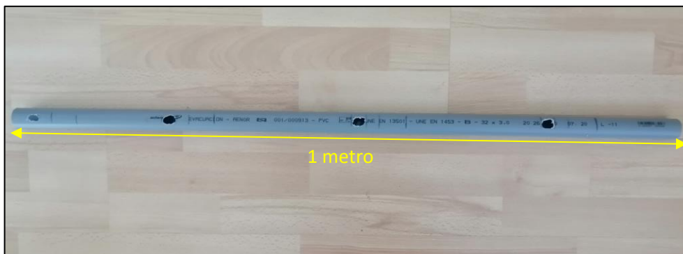
Figura 31. Tubo de PVC perforado para la inserción de los sensores.
