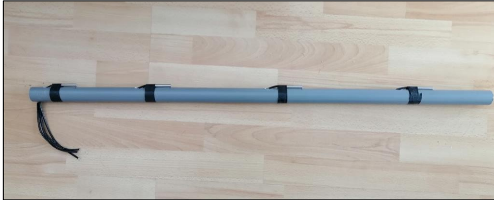
Figura 32. Inserción de los sensores de temperatura a través del interior del tubo.
